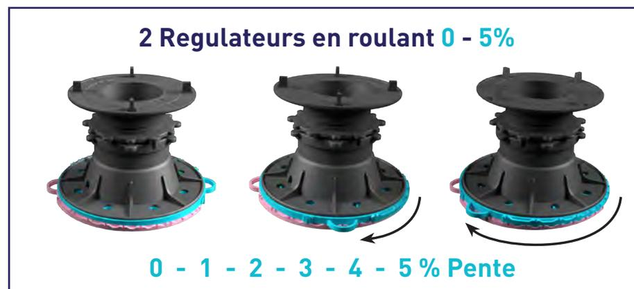
En associant plusieurs pièces nous pouvons obtenir tous les pourcentages d'inclinaison inférieurs au dénivellement maximum. Nous utilisons plusieurs régulateurs afin de parvenir à l'inclinaison exacte. Pour chaque cran pivoté du régulateur, nous rajoutons 0,25° d'inclinaison.
